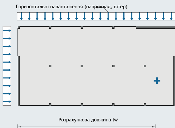
Рис. 4: Точка нульових переміщень біля краю (схематично)
