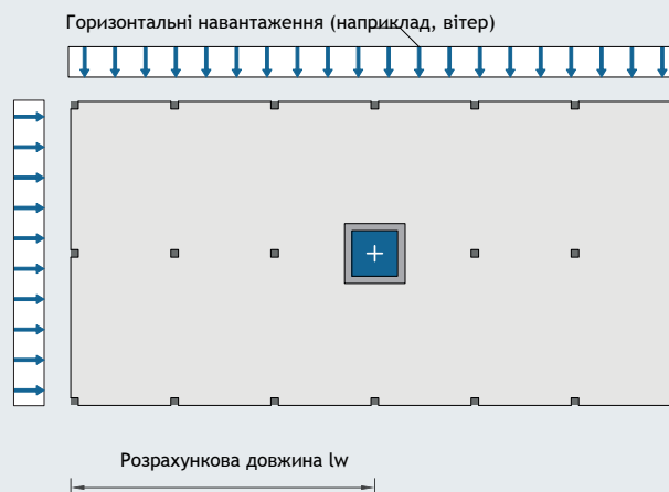
Рис. 5: Точка нульових переміщень у середині будівлі (схематично)
