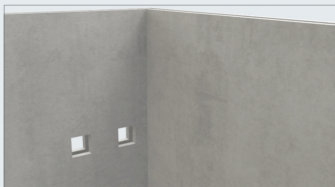
Рис. 46. Під час улаштування стін передбачити відповідні отвори для подальшого монтажу опорних елементів.
